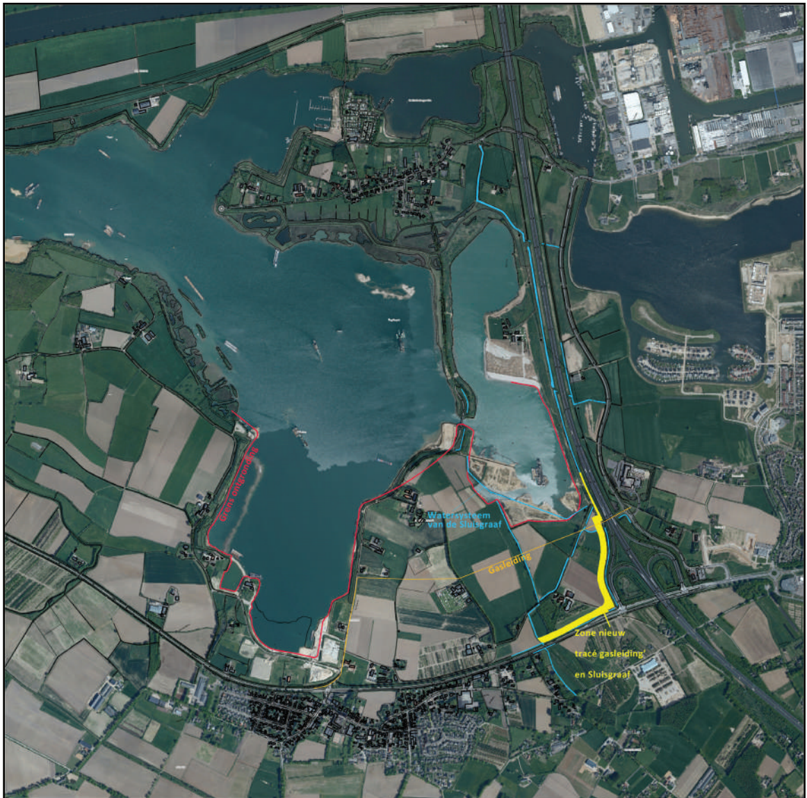
Afbeelding 16: De Sluisgraaf en de gasleiding worden verlegd, de gasleiding wordt parallel aan de N321 gelegd.
